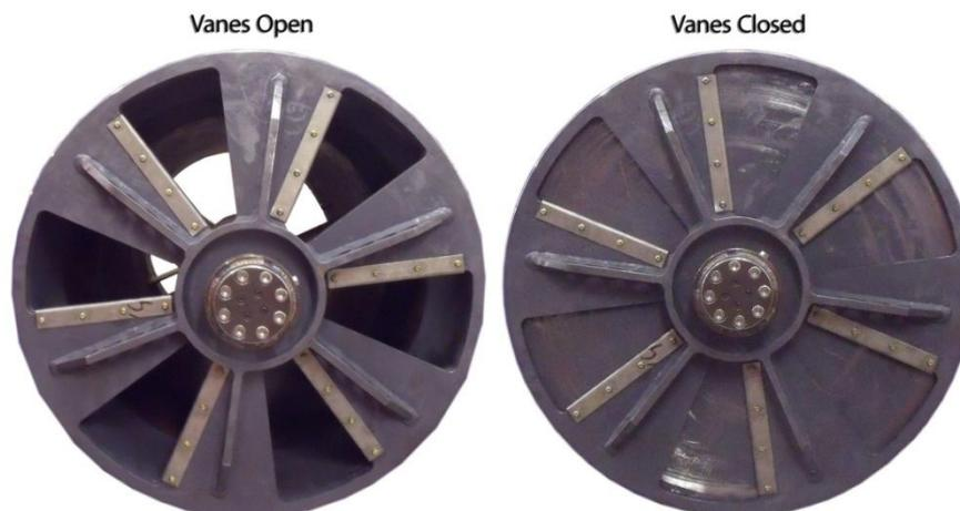
**Figure 2.2: Vane Positions**
